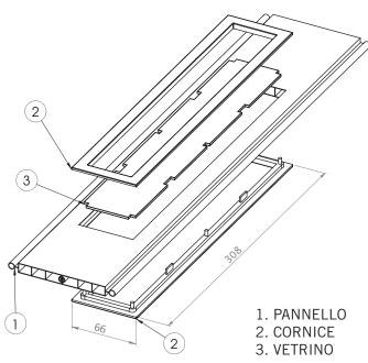
La finestratura standard per un'altezza di 220 cm è di 4 fori per pannello. Per 250 cm è di 5 fori per pannello. Finestrature diverse si possono fare su indicazione del cliente.
